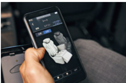
後席のアームレストに装備されたリヤマルチオペレーションパネルは取り外し可能。まるでスマホのように手元で扱える
